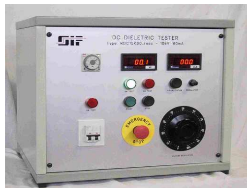
Aparato a 15 kV - 60 mA En versión de banco
