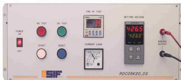
Alimentador Estabilizado 0 \div 500 V Corriente máx. absorbable 20 mA
