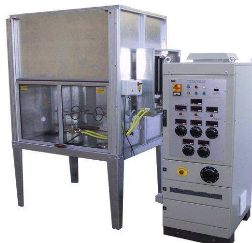
Armario aireado y cuadro eléctrico para prueba de resistencia al fuego según las normas IEC 60331
