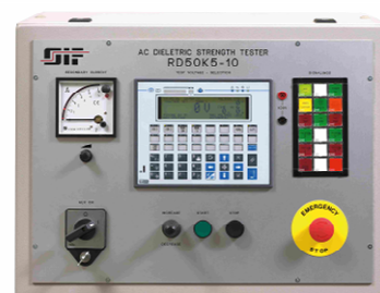
Banco de comando con PLC
