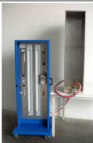
Prueba de no propagación de la flama con bunsen presurizado según las normas IEC 60332-1-1
